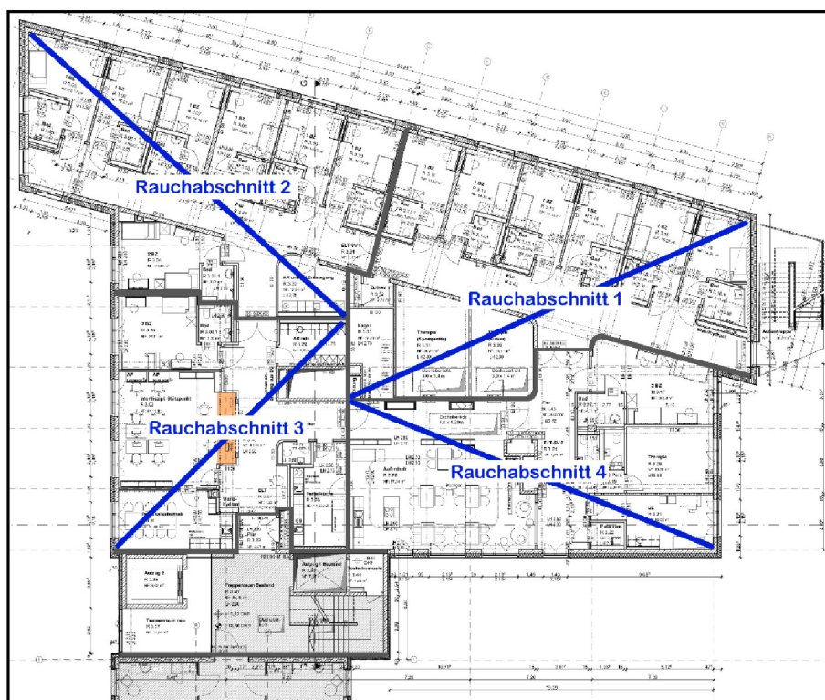
Abbildung 4: Einteilung in Rauchabschnitte im 3. OG, Quelle: /3.5/, bearbeitet durch den Unterzeichner
